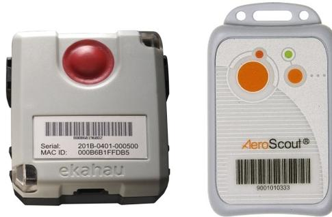
Figura 2.6. Dispositivi commerciali che fanno uso di reti WiFi. A sinistra l'*Ekahau* T201, a destra un modello *AeroScout* a forma di badge.
