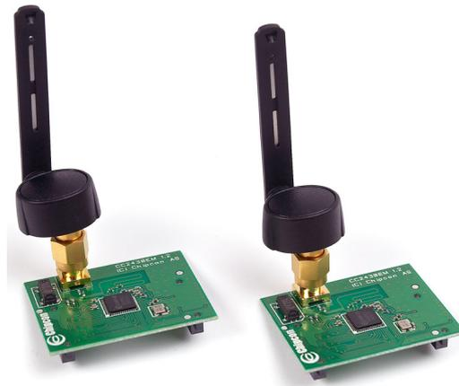
Figura 2.5. Moduli ZigBee *ChipCon* 2430 prodotti da *Texas Instruments*. Possono essere programmati sia per essere punti di riferimento sia per essere punti mobili in un sistema di localizzazione basato sull'RSSI.
